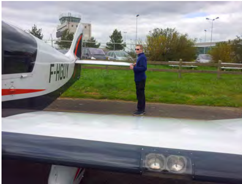
La visite prévol, vérification de la profondeur
